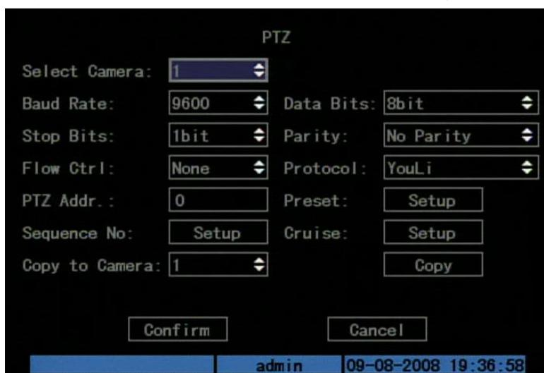
Fig. 5.31 PTZ parameters setup
